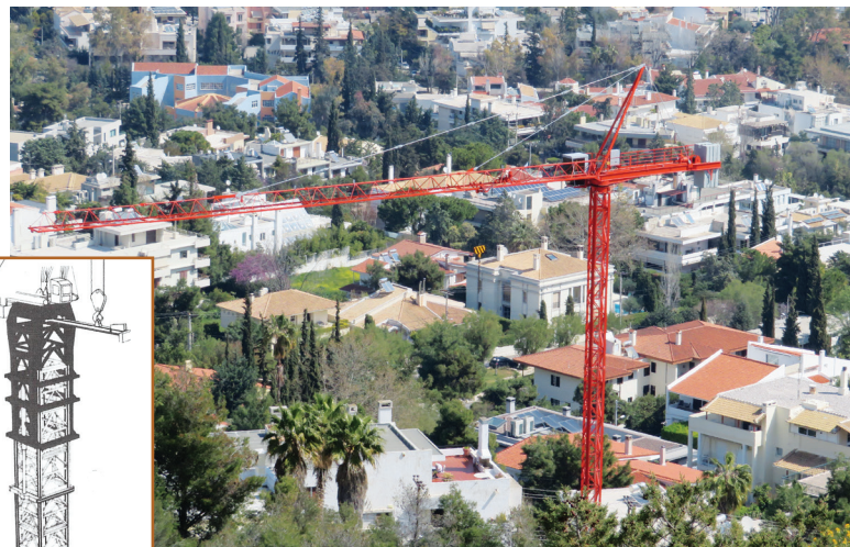
ΣΧΗΜΑ 2: Αναρριχώμενος πυργωτός γερανός (self-raising tower crane).
